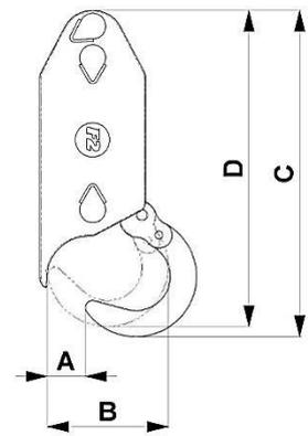
Gancio ad azionamento idraulico per la movimentazione delle campane di raccolta vetro e altri materiali
